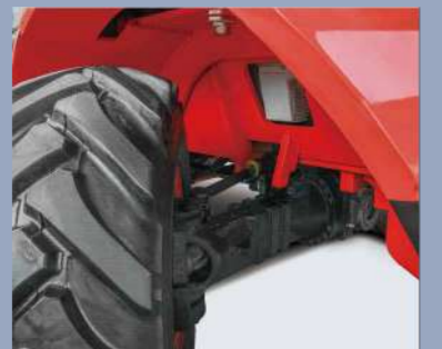
Die oszillierende Lenkachse ermöglicht es jedem Rad, über Hindernisse zu passieren, während der Stapler und die Ladung auf einem Niveau zu bleiben.
