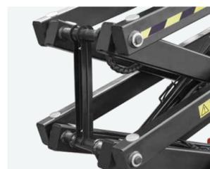
Eingeklemmte Finger bei Reparatur und Wartung sind nicht zu befürchten - spezielle Stützarme liegen vor.
