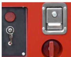
Selbst bei erschöpfter Batterie oder Versagen der Steuerung lässt sich die Bühne mit diesem manuellen Absenkehebel immer noch abwärtsfahren.
