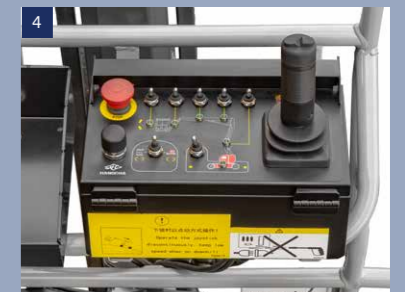
Mit dem Steuerkasten in der Plattform ist der Einsatzort schnell anzusteuern. Die Regler sind einfach verständlich
