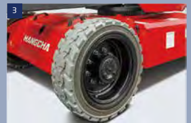
Reifen: schaumgefüllte Reifen mit guter Geländeleistung
