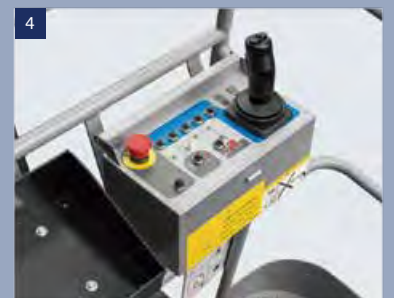
Korb-Steuerbox: Jede Aktion des Geräts kann über die Steuerbox gesteuert werden, um schnell zum Arbeitsbereich zu gelangen. Die Steuerung ist einfach und leicht zu verstehen
