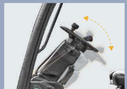
Das schmale Lenkrad lässt sich in der Neigung einstellen, so dass es jederzeit bequem in der Hand liegt.
