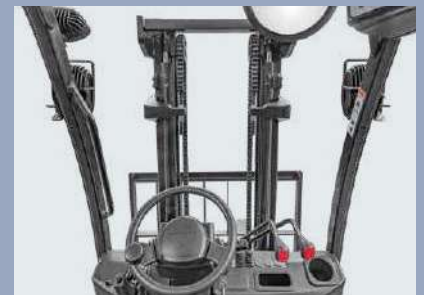
Das Weitsicht – Hubgerüst ist so orientiert, dass es die Sicht möglichst wenig behindert wird. Auch die verbreiterte Öffnung des Gabelträgers wirkt in diesem Sinn. Durch den hohen Angelpunkt des Neigungszylinders wird die Last optimal ausbalanciert, so dass sich das Hubgerüst stabil fahren lässt.
