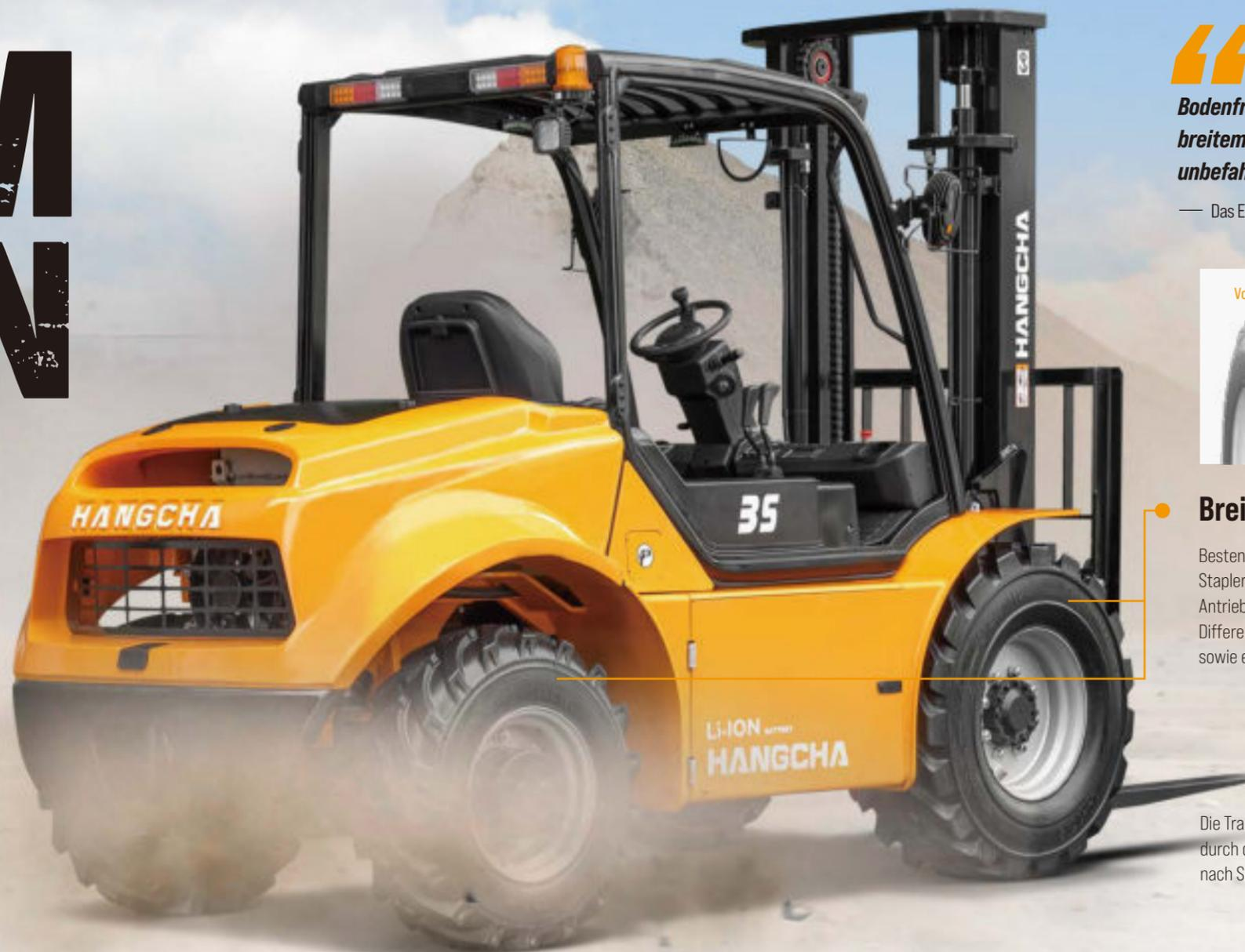
“ Ein großer Überhangswinkel, große Bodenfreiheit und schlauchlose Reifen mit breitem Profil – so bleibt kaum ein Gelände unbefahrbar!
