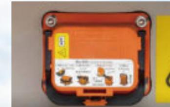
MSD – Wartungsschalter zum Abschalten auf Knopfdruck im Sinne der sicheren Wartung
