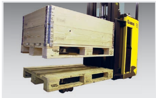
Das Heben der Radarme (Basishub) um die Bodenfreiheit zu erhöhen ist als Option erhältlich. Die Gabel und die Radarme können gleichzeitig mit Paletten beladen und bewegt werden. Zusätzlich ermöglicht eine höhere Bodenfreiheit verbessertes Fahren über Unebenheiten.
