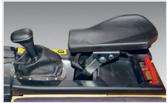
Der Joystick und die Armlehne sind aufgehängt um Vibrationen zu minimieren. Elektrischer Fingerschalter ist optional.
